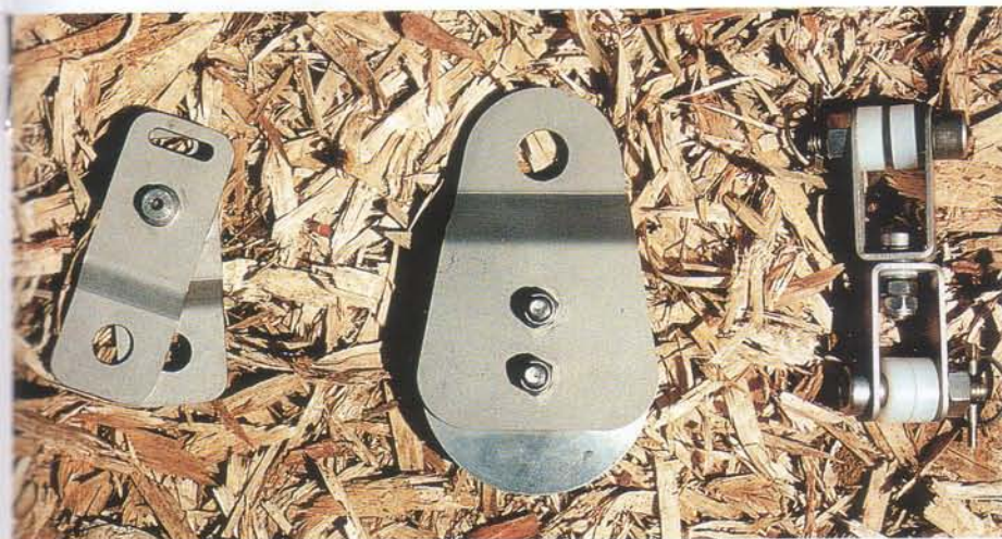
Materiaal: van links naar rechts: katrol, wrijvingsblok op 'spin static', wartel
